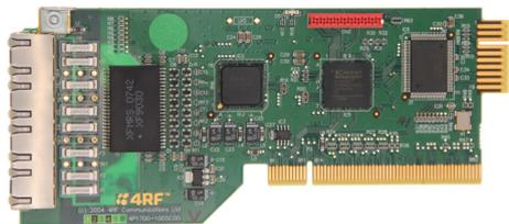
QJET est une interface numérique E1/T1 2 Mbit/s à quatre ports fournissant des interfaces non tramées (G.703) et tramées (G.704).
