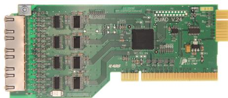
QV24 est une interface série à quatre ports qui permet la transmission de données V.24 en mode asynchrone et synchrone.
