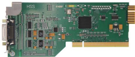
HSS est une carte d'interface série haute vitesse à port unique qui prend en charge la transmission synchrone de données V.35, X.21, RS-449 et RS-530 vers un équipement terminal de traitement de données et un équipement de transmission de données. Elle prend également en charge des débits compris entre 8 et 2 048 kbit/s par incréments de 8 kbit/s (en fonction du débit sélectionné). 8 kbit/s est utilisé pour les lignes de contrôle.
