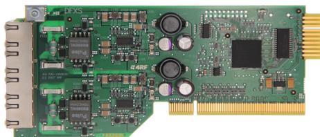
La fonction des circuits d'interface en boucle 2 fils FXO/FXS consiste à étendre de manière transparente l'interface 2 fils de la ligne réseau au téléphone/commutateur privé, si possible sans perte ni distorsion. Ces circuits sont appelés circuits d'interface en boucle 2 fils « émission, réception ». L'interface DFXS simule la fonction d'une carte de ligne réseau.
