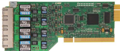
Q4EM est une carte d'interface analogique à quatre ports qui fournit un circuit analogique 4 fils et la signalisation E&M unique.
