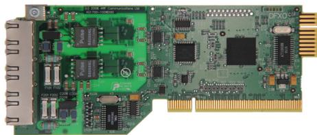
La fonction des circuits d'interface en boucle 2 fils FXO/FXS consiste à étendre de manière transparente l'interface 2 fils de la ligne réseau au téléphone/commutateur privé, si possible sans perte ni distorsion. Ces circuits sont appelés circuits d'interface en boucle 2 fils « émission, réception ». L'interface DFXO simule la fonction d'un téléphone.
