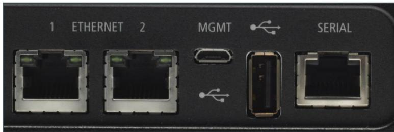
Aprisa SR+ ofrece cuatro **puertos de datos**, configurables para tener 2, 3 o 4 puertos Ethernet en una sola radio con el resto como RS-232; **máxima flexibilidad** para migraciones y dispositivos conectados.
