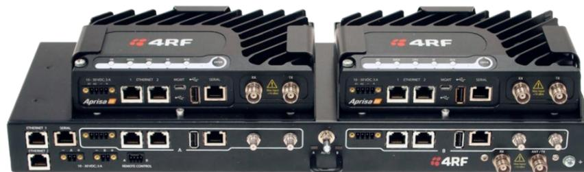
**Redundância** estão uma estação base padrão protegida e uma estação base protegida orientada por dados, ambas com capacidade de alternância automática.
