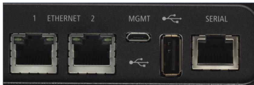
Aprisa SR+ stellt **vier Daten-Ports** zur Verfügung, die für 2, 3 oder 4 Ethernet-Ports an einem Funkgerät konfiguriert werden können, während der Rest als RS-232 zur Verfügung steht; **ultimate Flexibilität** für Migration und angeschlossene Geräte.
