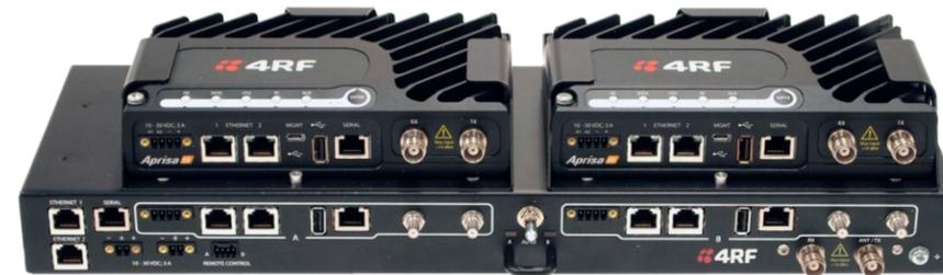
**Zu den Redundanzoptionen** gehört eine geschützte Standard-Basisstation und eine datengetriebene Basisstation, jeweils mit automatischer Umschaltfähigkeit.
